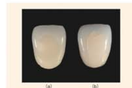
図4-6 合金の熱膨張係数が陶材より高い場合(a)と逆の場合(b)の焼付けた例
