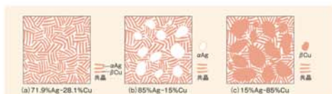
図1-5 Ag-Cu系合金の(a)共晶、(b)共晶と銀固溶体および(c)共晶と銅固溶体の結晶組織の模式図
