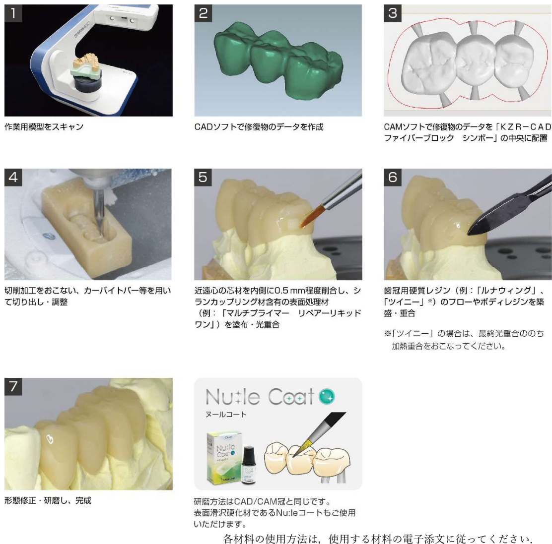
図 4-2-1 ブリッジの製作手順
