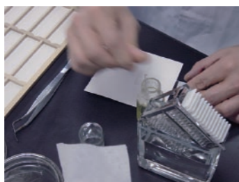
カバーガラスをかけプレパラート状の永久標本を完成させる。
