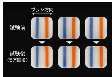
図 4-12 歯ブラシ摩耗試験による耐剥離性
