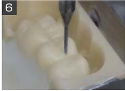
6 「KZR-CAD HR ブロックロングハード /GR」で被覆冠を製作。(切削加工後、カーバイトバー等を用いて切り出し・調整)
