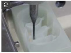
2 「KZR-CAD ファイバーブロックフレーム」でフレームを製作。(切削加工後、カーバイトバー等を用いて切り出し・調整)
