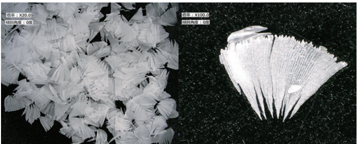
図16 加工後の切りくず（左：20倍拡大 右：100倍拡大）
