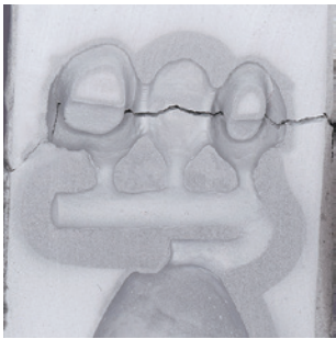
図24 ヒートショック焼成によるクラック
