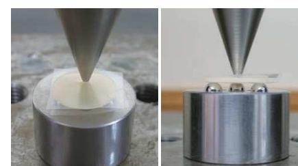
図6 2軸曲げ試験装置
