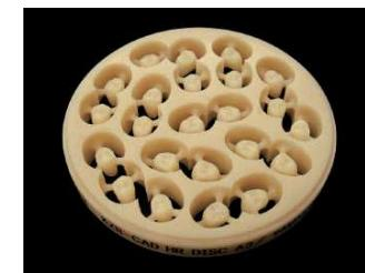
図27 ハイブリッドレジンディスクの切削例
