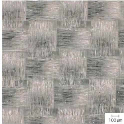
図 3-3 「ファイバブロック」の上面（咬合面側）および下面のガラス繊維 ※歯科用樹脂含浸後はガラス繊維の構造が観察しづらいため、含浸前のガラス繊維を観察
