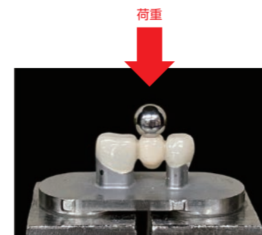
破壊試験片と荷重方向
