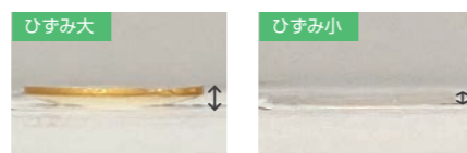
比較用試作品 リキッド クリアー ペレット厚み: 0.3mm
