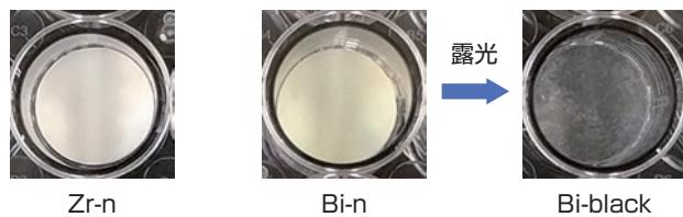
図5-3 Zr-nと露光前後の酸化ビスマス含有試作MTAセメント
