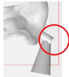
図2-8 ノブを挟み込むように付与したサポートピン
